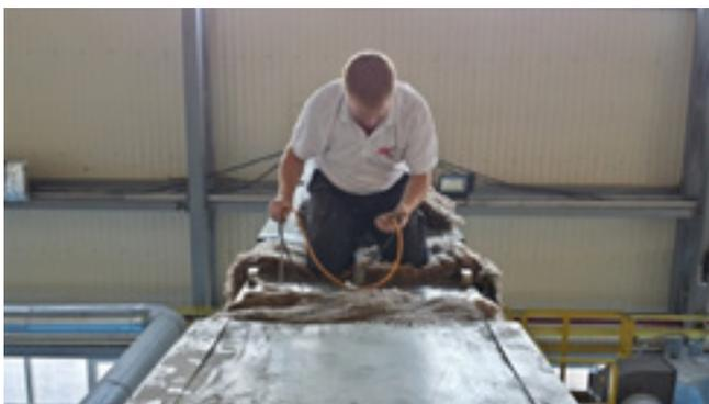
Измерение скорости потока воздуха в печи во время проведения термического аудита
